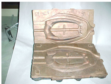
Figura 5 Coquilha metálica destinada ao fabrico de torneiras por fundição.
