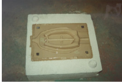
Figura 2 Moldação cerâmica compósita constituída por uma casca cerâmica (cor escura) que reproduz os detalhes do modelo e por uma camada de enchimento que dá a resistência à moldação compósita.
